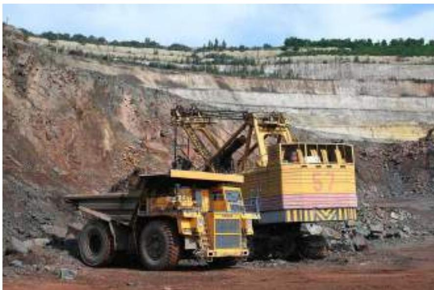
**Рис. 4.8. Погрузка горной массы в автомобили БелАЗ (СГОК)**
