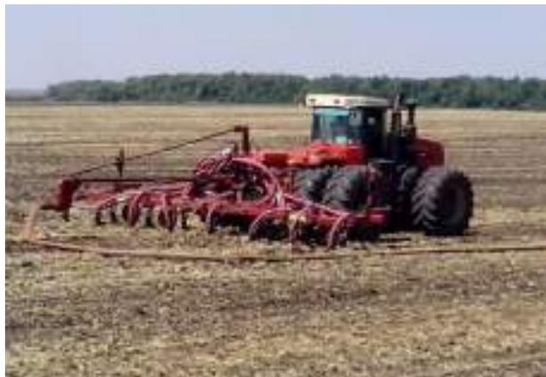
**Рис. 4.49. Дозированное внесение животноводческих стоков в почву**
